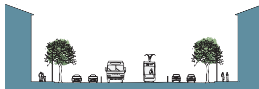
Sektion genom länken från söder, pulsådern in till Kärra centrum, både för bilar, cyklar och kollektivtrafik. En bred sektion ger plats för olika trafikslag. Här visas spårväg i gatan.
