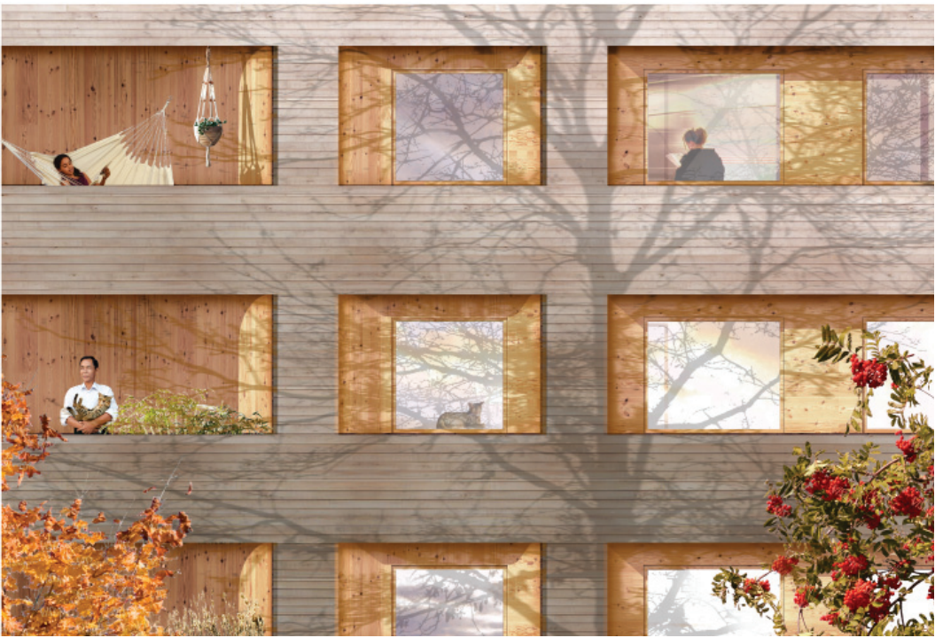
Fasadutsnitt. I de indragna gemensamma balkongerna ska man bekvämt kunna sitta och betrakta omgivningen utan att behöva vara exponerad i gaturummet. Bakom rundningen finns plats för förvaring av möbler mm samtidigt som man genom slitsar i materialet ska kunna sila in ljus till det bakomliggande trapphuset.
