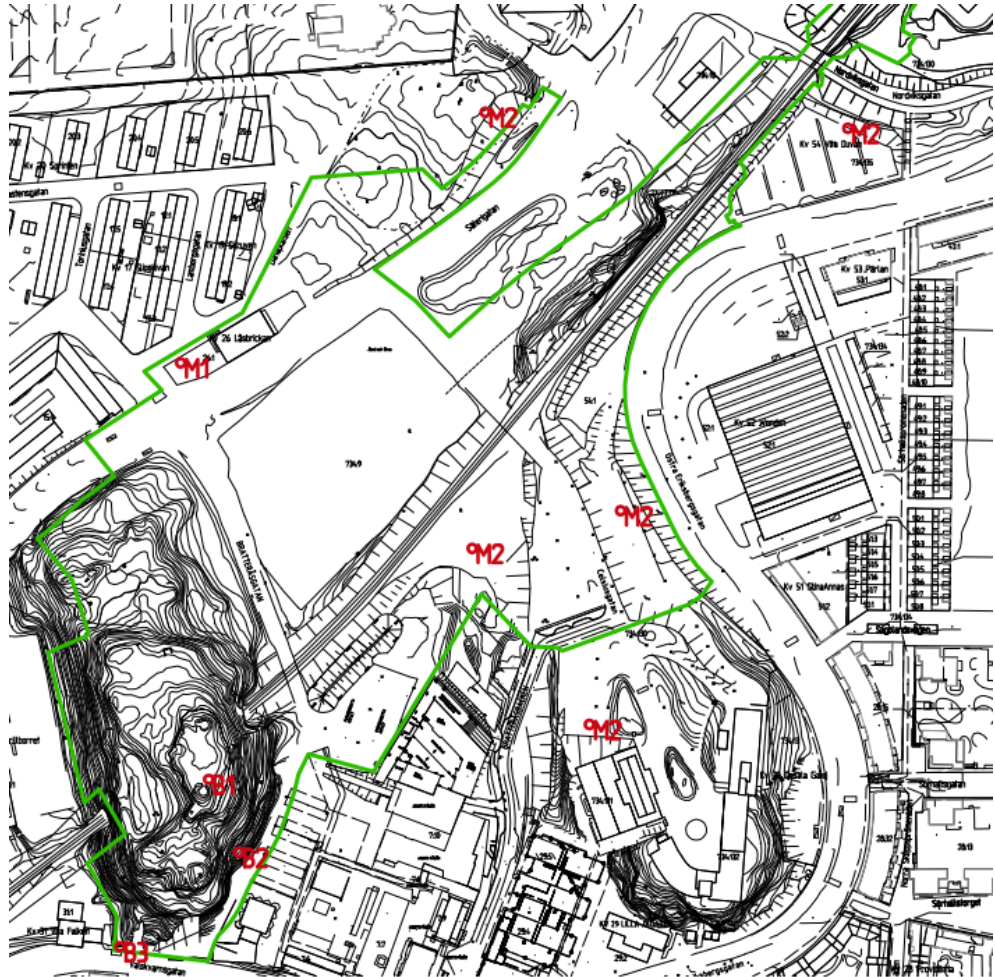
Figur 7.1 Placering av gammastrålnings- och markradonmätpunkter. Gammastrålningsmätningarna på berg är numrerade med B i början och markradonpunkternas numrering börjar med M.
