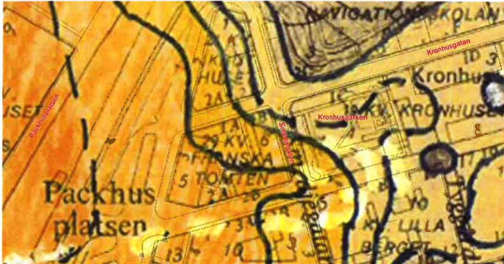
Stadsbyggnadskontorets handritade jordartskarta visar på varierande lermaktigheter inom fastigheten, med ökande djup mot sydväst.
