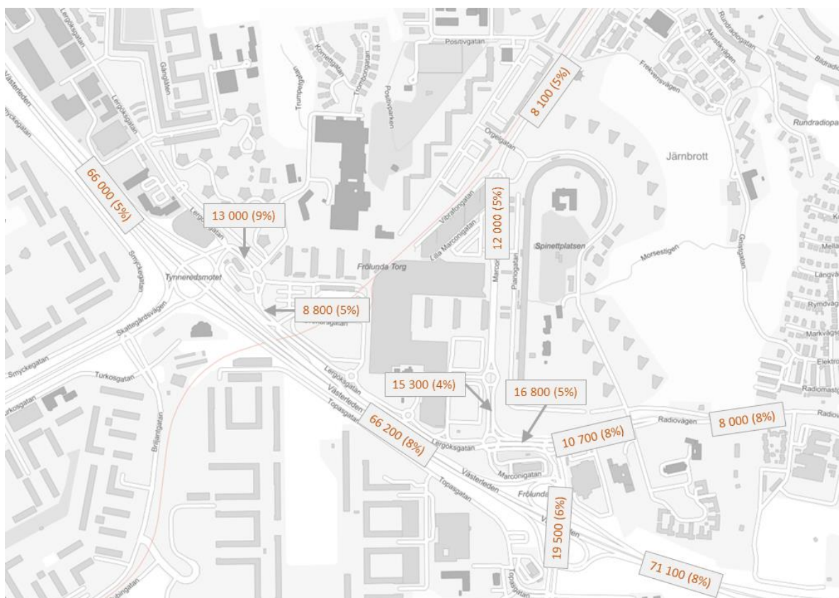
Figur 2 Uppmätta trafikmängder för ett vardagsmedeldygn. Inom parentes anges andel lastbilar av den totala trafiken. Källa: Göteborgs Stad Trafikkontoret, mätår 2017. För Söder/Västerleden har uppgifterna hämtats från Trafikverkets trafikflödeskarta på Internet, mätår 2018. Trafikverket anger trafikmängder i årsmedeldygnstrafik. Dessa har räknats om till vardagsdygn med faktor 1,1.
