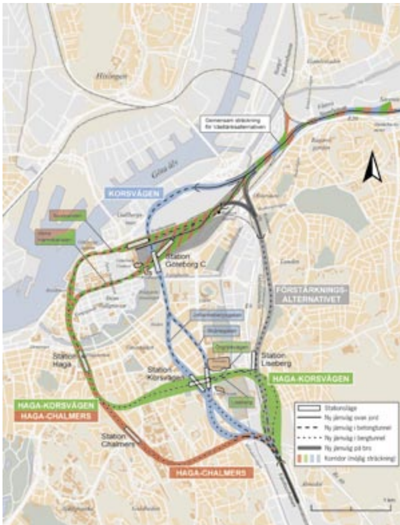
Nollalternativet innebär ingen kapacitetsförstärkning vid Göteborg C. Förstärkningsalternativet innebär en fördubblad Gårdatunnel med bibehållen - och utvidgad - säckstation vid Göteborg C.
