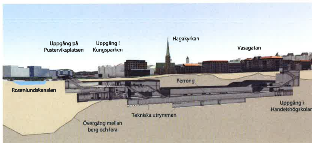
Bilden visar en sprängskiss genom stationen i Haga. (Järnvägsplan Västlänken, fastställelsehandling 2015-09-01). Bild framtagen av WSP.
