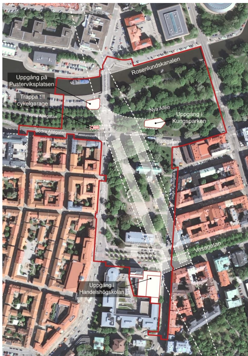
Bilden visar stationens utbredning under mark med vit streckad linje i enlighet med järnvägsplanen.
