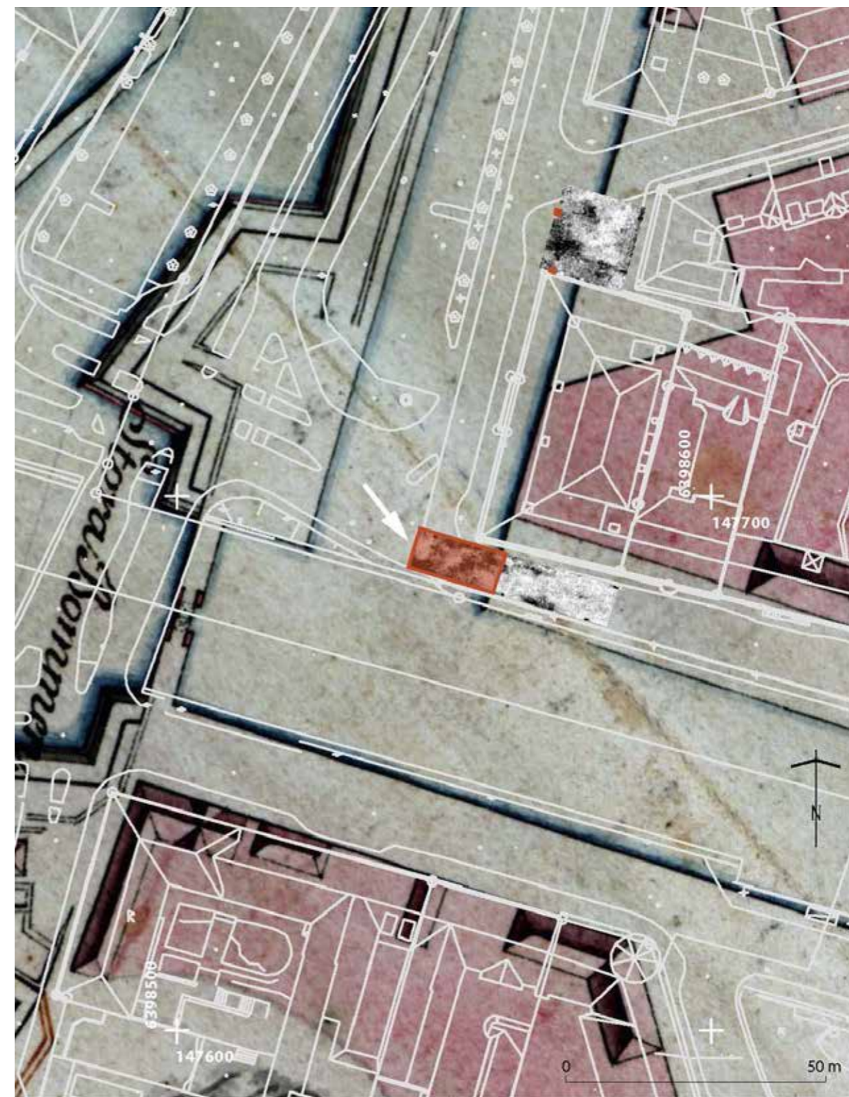
Läget för den äldsta masthamnens kortsida kunde inte fastställas vid den arkeologiska förundersökningen. Georadarundersökningar genomfördes som komplement. Ovan; ett utsnitt av karta från 1769 och dagens fastighetsskarta med de båda prospekterade ytorna markerade. De kraftigt reflekterande fyllnadsmassorna i väster är markerade med rött på undersökningsytan i Norra Hamngatan och tolkas vara Masthuggsbassängen. Skala 1:1000.
