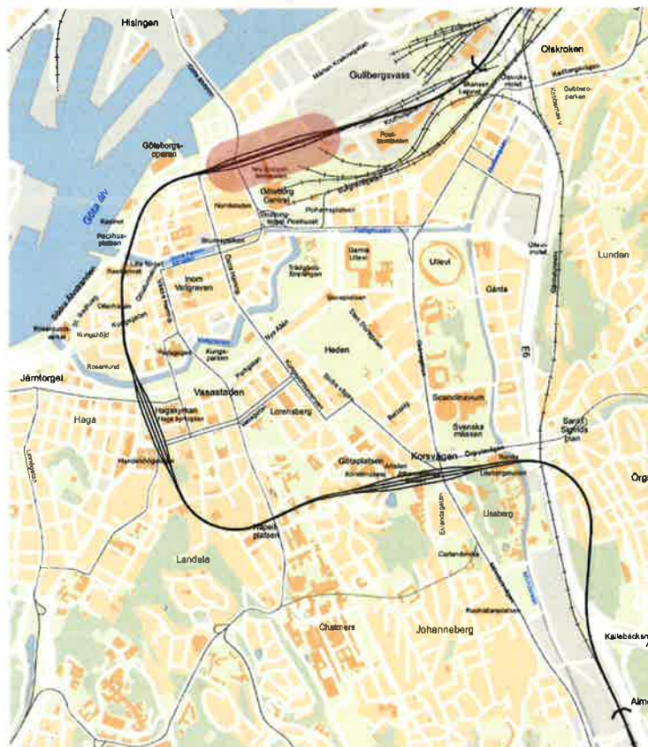
Översiktsbild av Västlänkens tunnelsträckning genom Göteborg med stationer vid centralstationen, Haga och Korsvägen. Ellipsen i röd skuggad färg visar Station Centralens placering. Bild WSP
