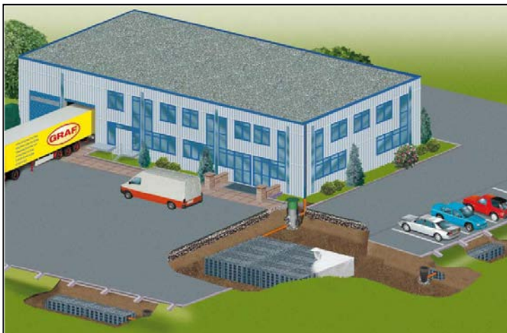
Figur 33. Exempel på utjämningsmagasin bestående av dagvattenkassetter (Uponor)
