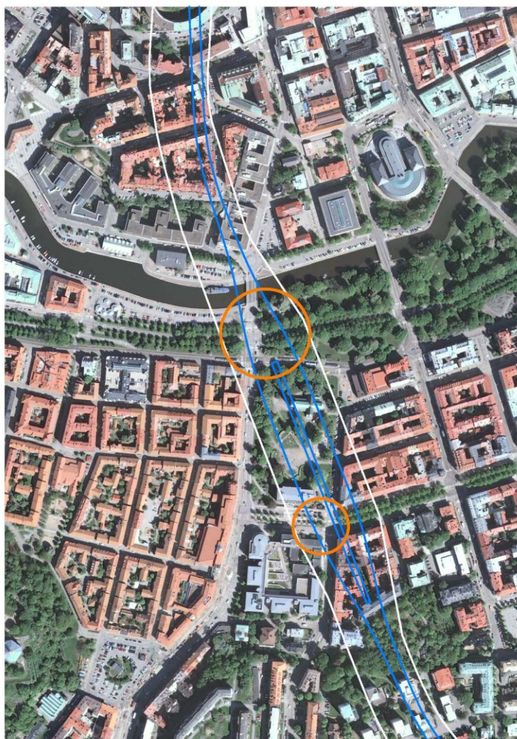
Bilden visar korridoren för tillåtligheten (vitt) och läget på Station Hagas plattformar (blått) under Haga Kyrkoplan. Cirklarna visar tänkta lägen för uppgångar i stationens norra och södra ändar.
