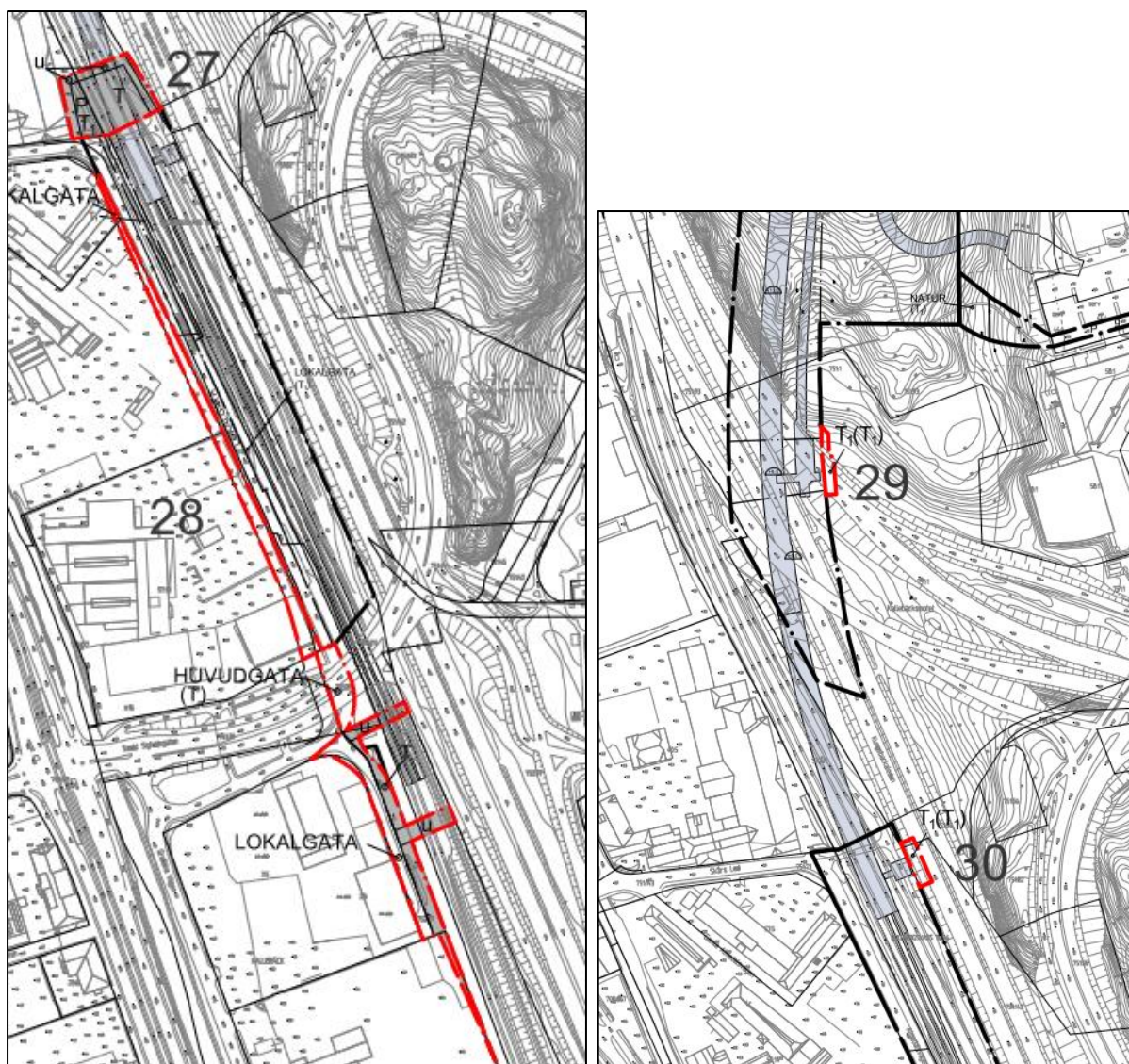
Figur 20 Området för Almedal, ledningsrätt och lokalgata till vänster samt vändplats och serviceutrymme under mark till höger. Röda linjer visar de kompletteringar som samrådet avser. Områdena identifieras med stora svarta siffror. Numreringen refereras till i texten.
