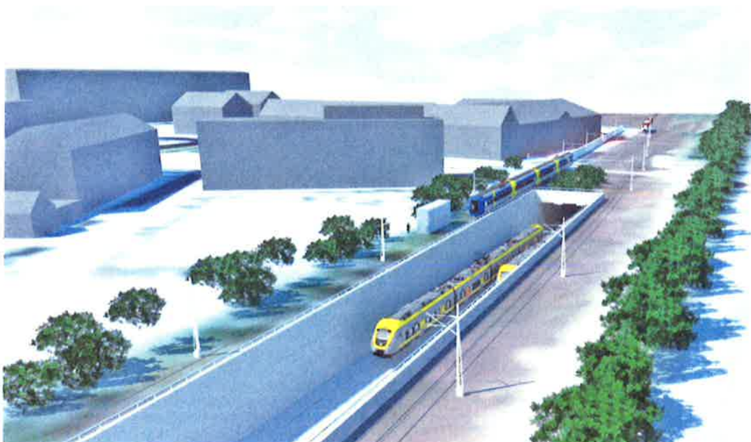
Vid Almedal kommer Västlänken upp från tunneln och ansluter till befintliga spår söderut.
