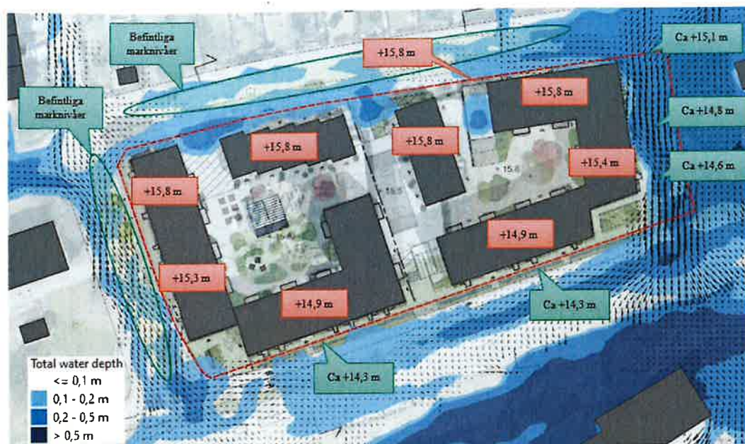
Figur 34 I rött visas rekommenderade minimihöjder till golvnivåer för att uppnå TTÖP. (höjderna motsvarar 20cm över förväntat vattennivåer vid byggnaderna). I grönt visas rekommenderade marknivåer utanför nya byggnaderna. Illustrationen visar ett tidigare förslag för bebyggelsen som inte längre är aktuell. Däremot påverkar det inte de förslagna minimihöjderna.
