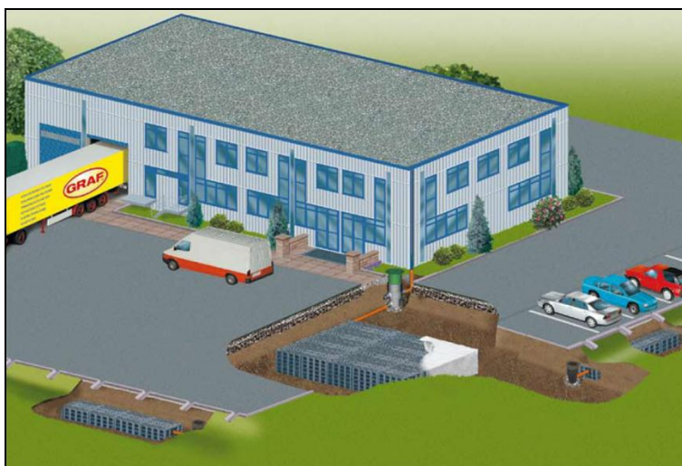
Figur 12. Exempel på utjämningsmagasin bestående av dagvattenkassetter (Källa: Uponor)
