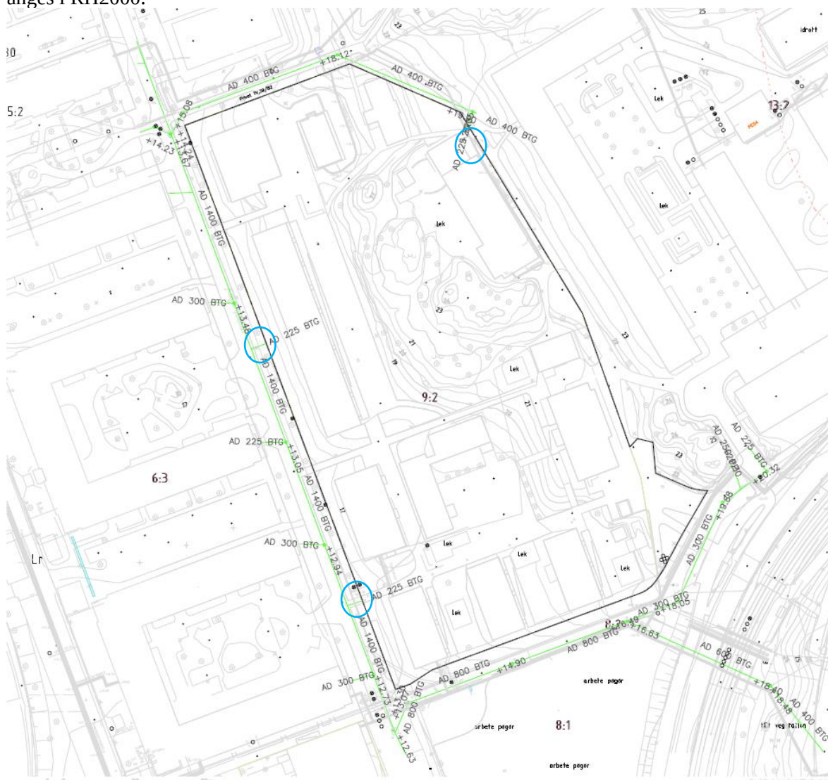
Figur 9. Befintliga dagvattenledningar kring planområdet. Befintliga anslutningspunkter är markerad med blåa ringar. Plangräns är markerad med svart färg.
