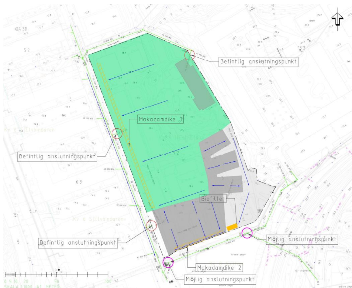
Figur 13. Avvattningsplan. Ytliga rinnstråk symboliseras med blå pilar. Grön yta motsvarar skolgård, mörkgrå yta motsvarar taktytor och ljusgrå ytor motsvarar angöringsytor. Röda ringar symboliserar befintliga anslutningspunkter och lila ringar symboliserar möjliga anslutningspunkter efter exploatering.
