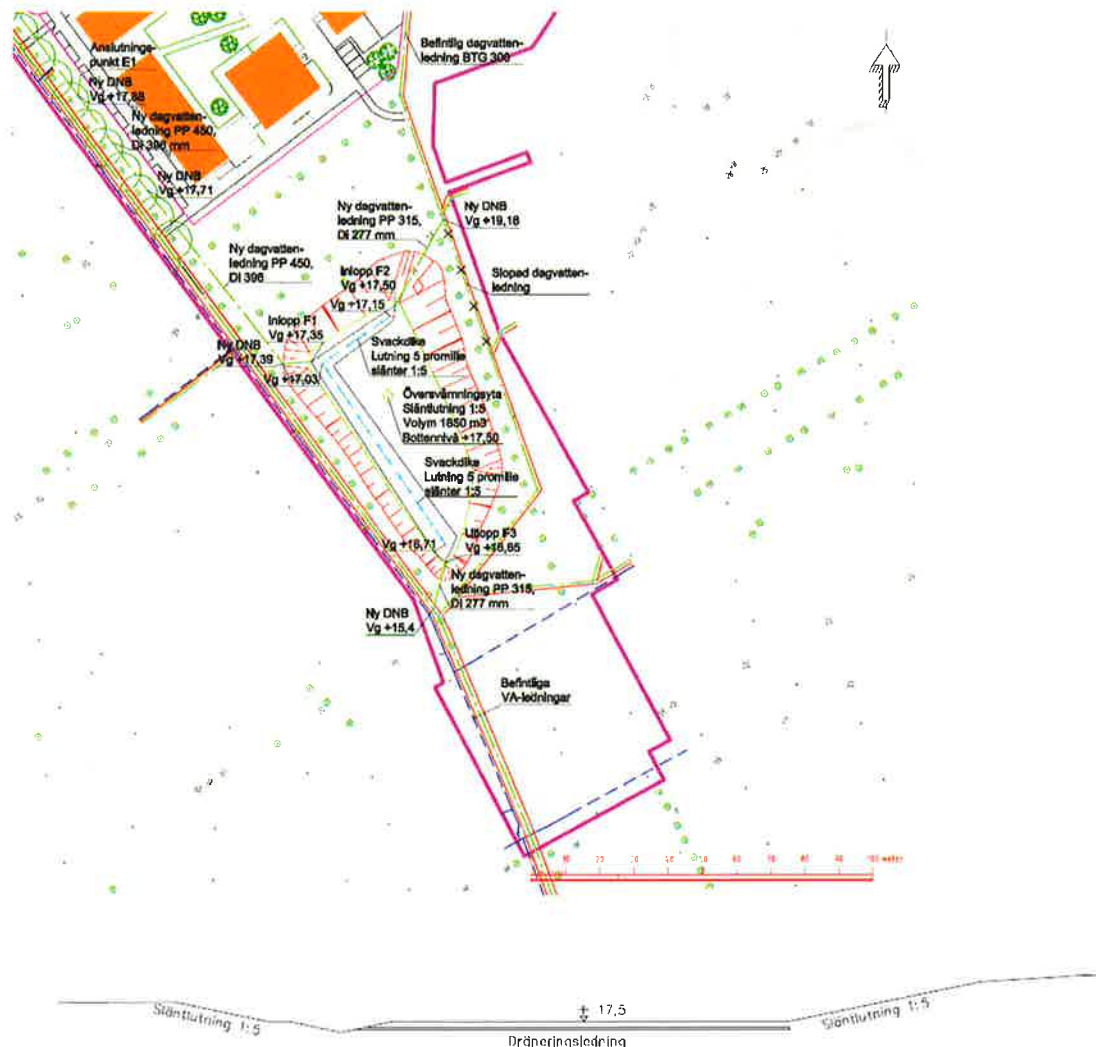
En möjlig utformning av fördröjningsytan. Utdrag ur dagvattenutredning 2015-12-18
