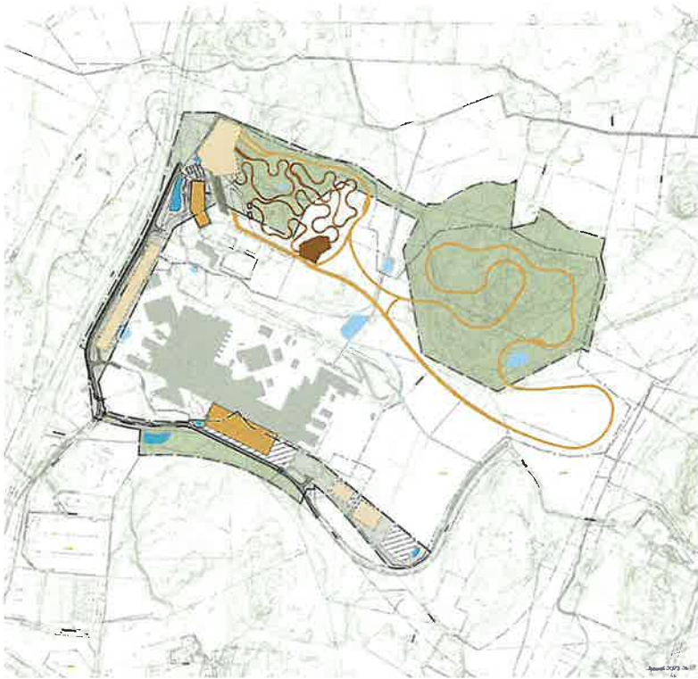
Figur 2: Illustrationskarta som visar maximal byggrätt inom planområdet. Gula figurer; Planerad tillkommande bebyggelse, Ljusgul; Möjlig ytterligare bebyggelse. Grått; hårdgjord mark. Kurvade linjer; demobanor (bruna terräng, gula asfalterade). (Liljewall arkitekter, 2023)
