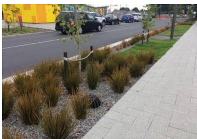
Exempel på makadamdike som täckts med växter och gräs
