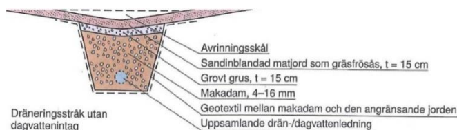
Exempel på makadamdike som täckts med växter och gräs
