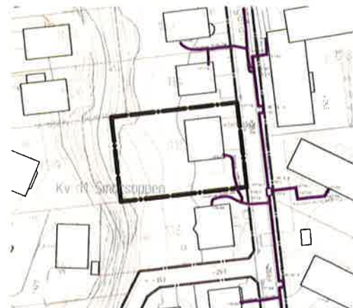
Fjärrvärme och optonät, Göteborg energi
