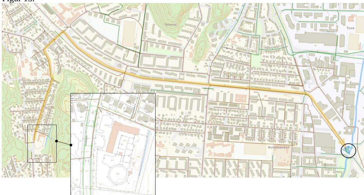
Figur 13 Karta över avrinningsområden och dagvattenförande ledningssystem. Gul linjen visar avledningen från planområdet. Utloppet vid bräddning markeras med svart cirkel.
