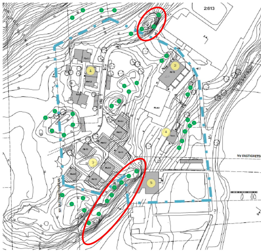
Figur 3, Röda ellipser visar slänter där risk för blocknedfall finns. De gröna markeringarna visar lägen för gammastrålningsmätning.
