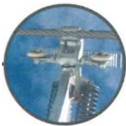
Figur 3 Avkopplingsbar klämma. (Foto från CUP 2013)
