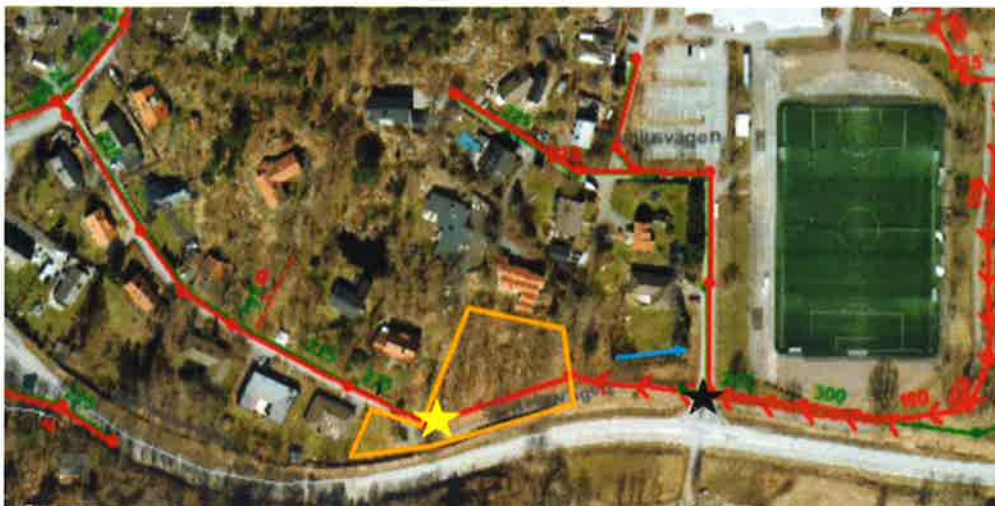
Ledningskarta på ortofoto med planområde (gul linje), anslutningspunkter (gul och svart stjärna) och lågstråk i form av diken (blå pil).
