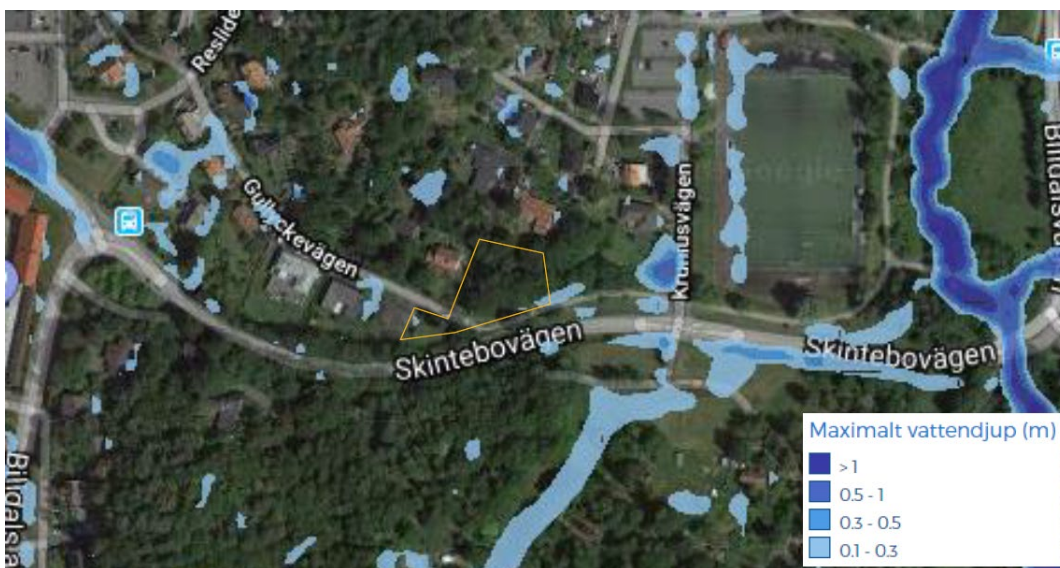
Bildkarta på ortofoto redovisar skyfallskartering av ett 100-årsregn med planområdet (gul helstreckad linje). Karteringen redovisar lågpunkter, utströmningspunkter eller instängda områden är olämpliga för byggnation.
