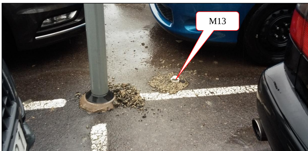
Figur 4. BH13 med grundvattenrör.
