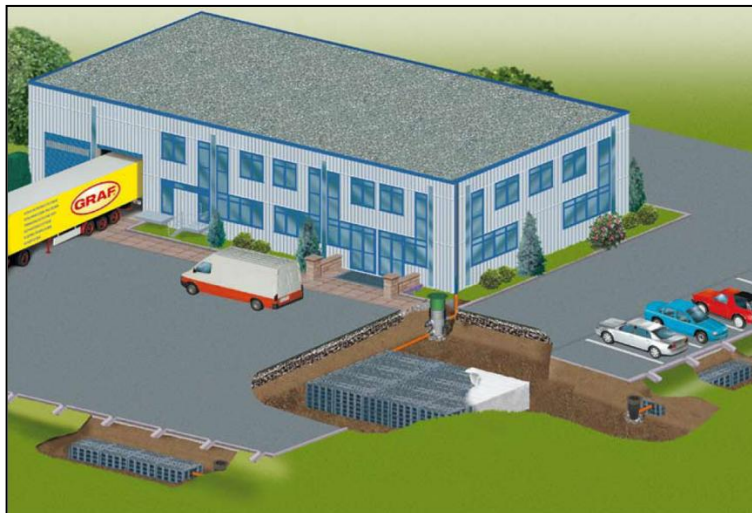
Figur 21. Exempel på utjämningsmagasin bestående av dagvattenkassetter (Uponor)
