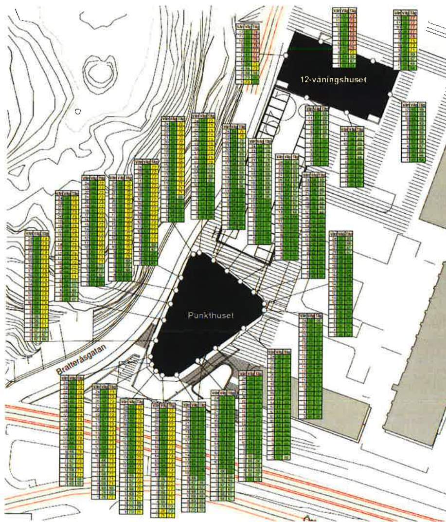
Maximal ljudnivå år 2030 med hamnbanan kvar och bullerdämpande åtgärder gjorda enligt ovan.
