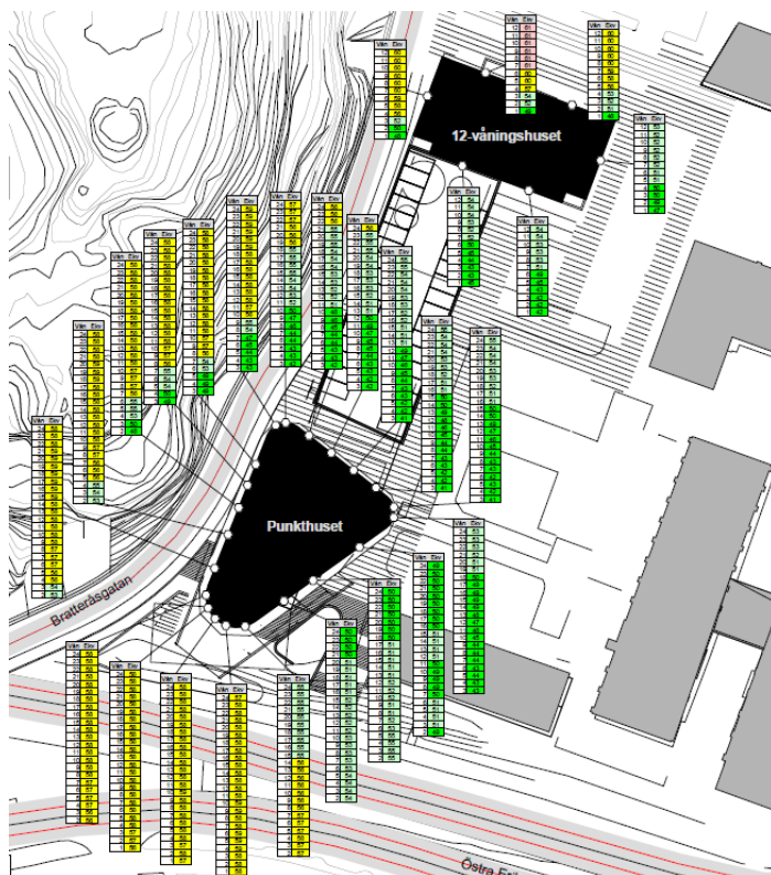
Bullerbild för ekvivalent bullernivå i nuläget. Grönt markerar buller under 55 dBA. Gult markerar buller överstigande 55dBA.
