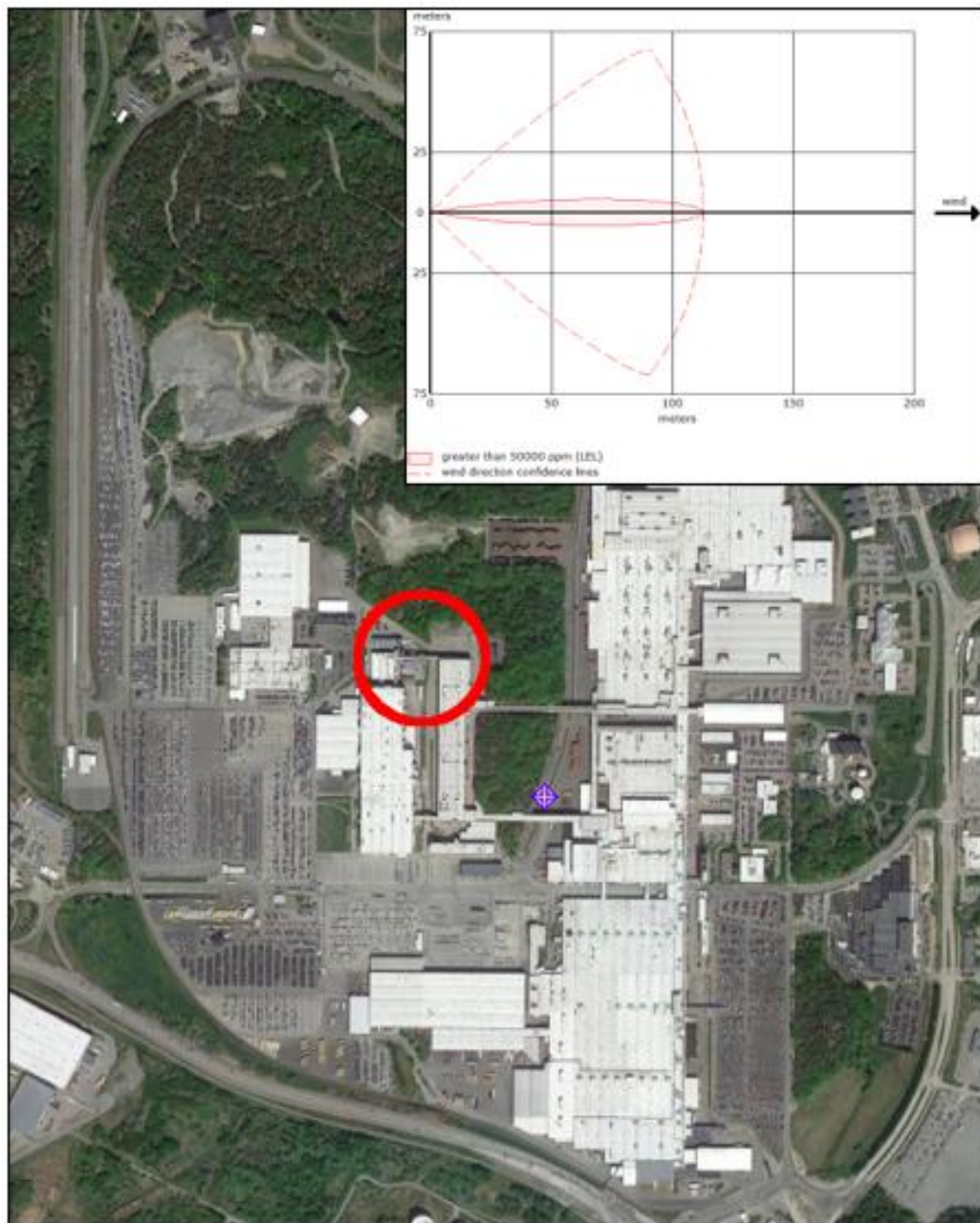
Figur 5. Konsekvensområde (100% LEL) för ett fullständigt rörbrott vid en antagen rörledning om 50 cm och ett tryck om 4 barg.
