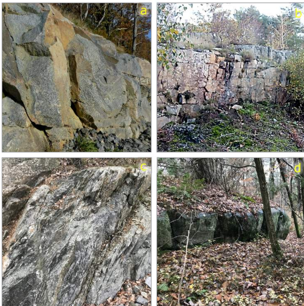
Figur 8. Blockighetens karaktär varierar i bergmassan. a) Veckad bergmassa i områdets sydöstra del, b) likformigt uppsprucken bergmassa norr om Volvo Cars TUN, c) skivigt berg i närheten av krocktestanläggningen, d) prismatiskt berg norr i områdets norra del.
