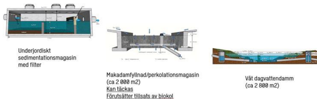
Figur 50: Föreslaget system för dagvattenrening för att inte begränsa möjligheterna att uppnå miljö kvalitetsnormerna (Sweco, 2024).
