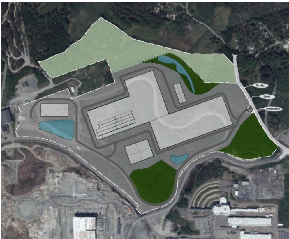
Figur 9: Illustrationskarta över möjlig utveckling inom planområdet. Vita ytor avser industribyggnader, grå ytor hårdgjorda ytor asfalterade parkering, uppställning och vägar, mörkgröna ytor kvartersmark som avses nyttjas som naturytor för dagvatten- och skyfallshantering, ljusgröna ytor allmän platsmark för natur. (Stadsbyggnadsförvaltningen, 2025)
