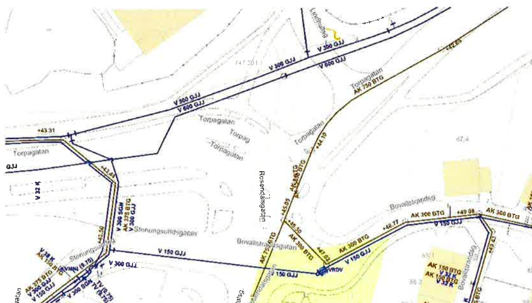
Figur 4. VA-ledningar tillhörandes förvaltningen kretslopp och vatten.
