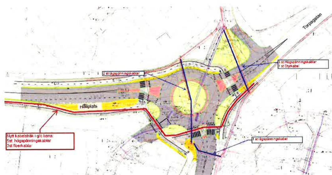
Figur 5. Blå feta linjer är befintliga, röd fet linje är kommande ledningar tillhörande Göteborg Energi Nät.
