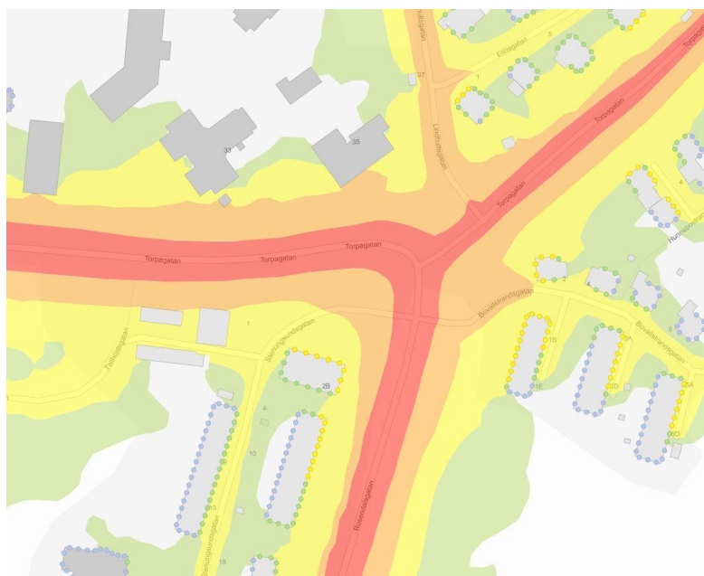
Figur 7. Kartan visar ungefärliga bullernivåer vid korsningen i dagsläget. Grönt är 50–55 dB, gult 55–60 dB, rött 60–65 dB.
