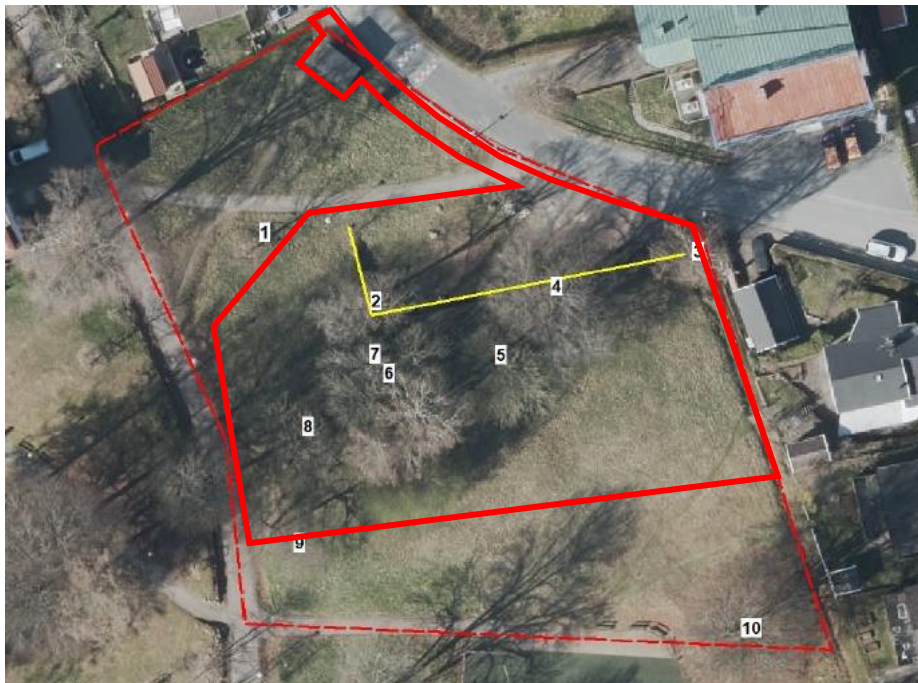
Träden och den kallmurade stödmurens lägen inom området. De särskilt skyddsvärda träden är en alm (4) och en ask (5). Även boken längst i sydöst (10) bedöms vara särskilt skyddsvärd men den hamnar utanför planområdet (heldragen röd linje). Stödmurens läge är markerat med gul linje. Illustration: Park och naturförvaltningen
