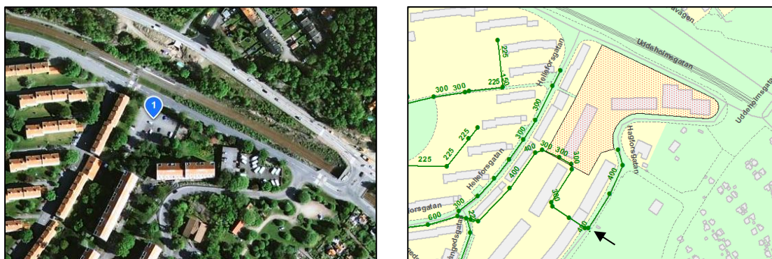
Figur 1. Vänster: Foto över planområdet. Höger: Dagvattensystemet i området. Pilen visar var resterande del av detaljplanen förväntas ansluta till dagvattennätet.
