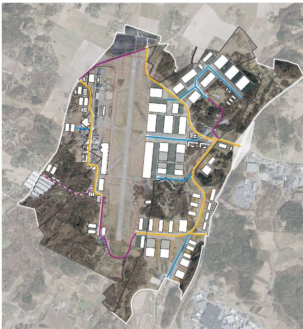
Figur 17. Orangemarkerade gator föreslås ha en bredd på 25 meter med typsektion för tvärlänk och huvudgator. Lokalgator i blått föreslås ha en bredd på 16 meter. Föreslagna gång- och cykelvägar illustreras med lila.
