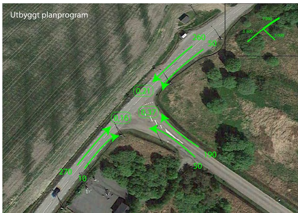
Figur 24. CapCal-analys för korsningen Kongahällavägen – Säve Flygplatsväg som visar på god kapacitet när planprogrammet är utbyggt. Trafikmängderna baseras på trafikmätningar från 2019 som räknats upp 2040-års trafikmängder och har kompletterats med trafiklastring från planprogrammet.
