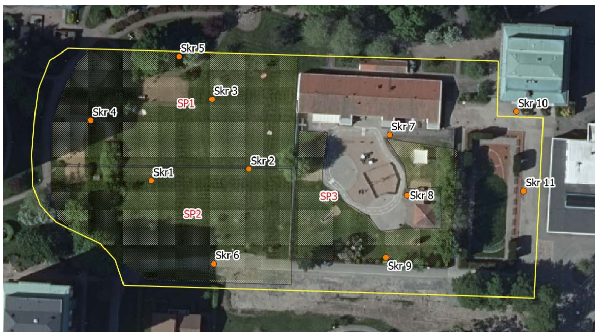
Figur 6. Förslag till provtagningsplan för DP Gitarrgatan. Skr betyder skruvborrningspunkter och de gula transparenta områdena är områden för ytlig samlingsprovtagning (SP).
