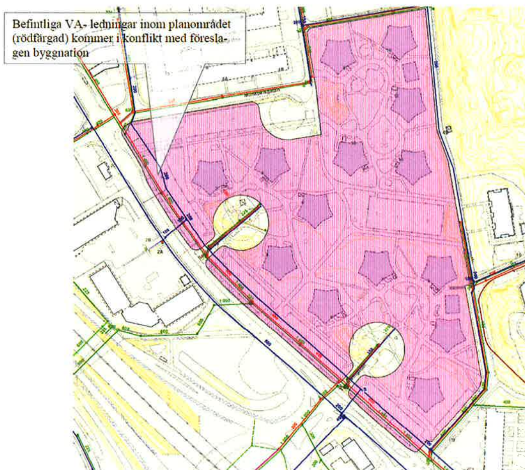
Bild: Befintliga VA-ledningar i området.
