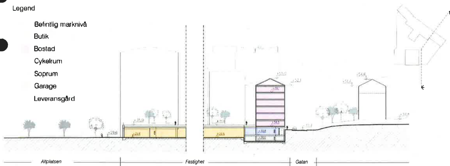
Figur 16. Exempel på sektion som visar hur sockeln med handel, garage och cykelrum i relation till bostäderna kan anordnas. Equator Stockholm AB.
