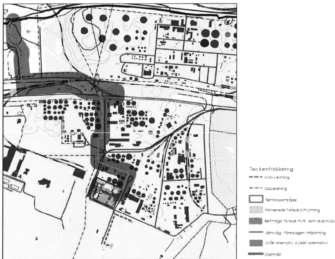
Figur 7 Föreslagen dragning av gasledning till stamnätet.
