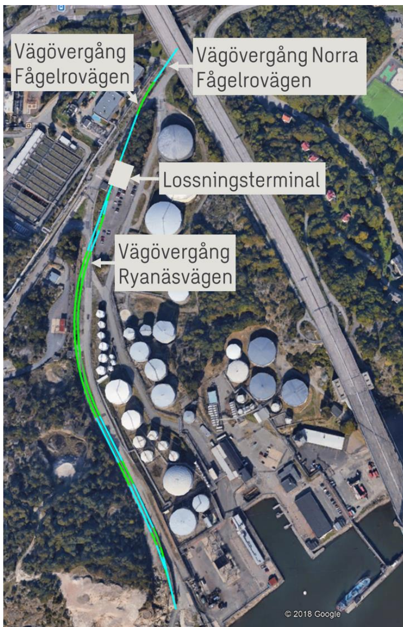
Figur 10. Spårutformning med ungefärlig lokalisering av lossningsterminal samt vägövergångar. (Bildkälla: Idéstudie, Järnvägsanslutning Rya Biokraftvärmeverk, Göteborg Energi, Sweco 2018-08-31)
