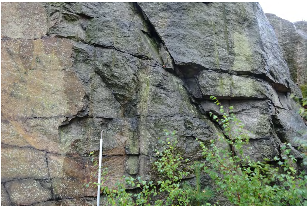
Bild 15 tagen på ställe S3 där några mindre block bör skrotas ner (strax till höger om mitten).
