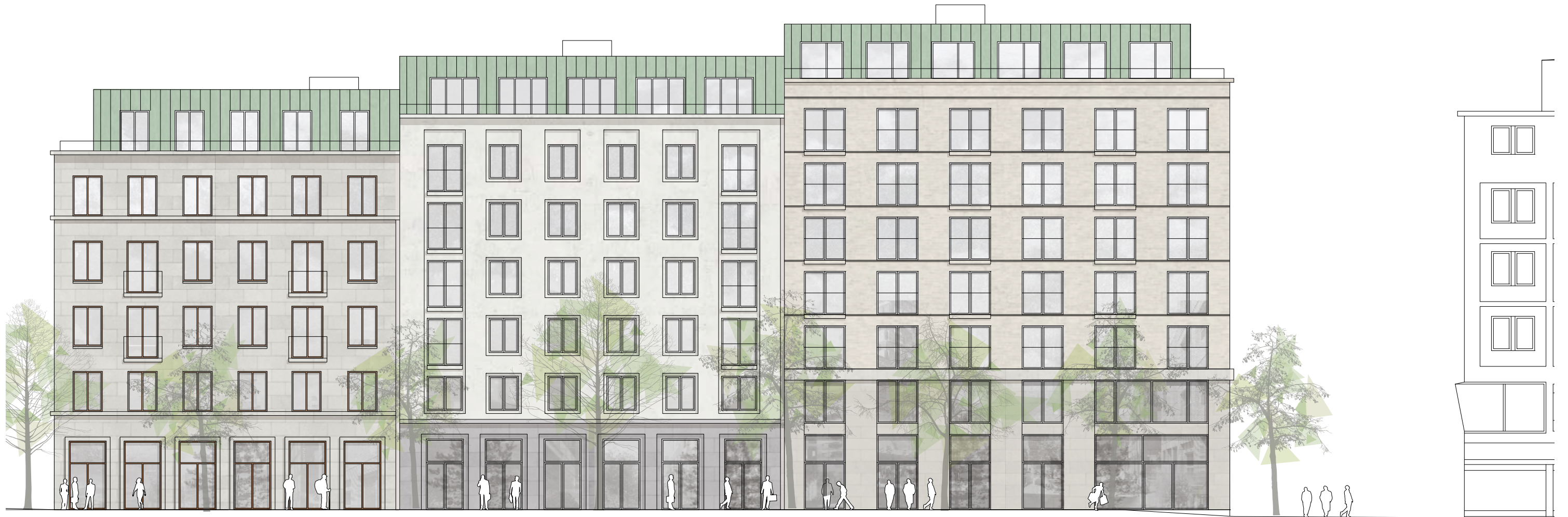
FASAD MOT JÄRNTORGSGATAN SKALA 1:200
