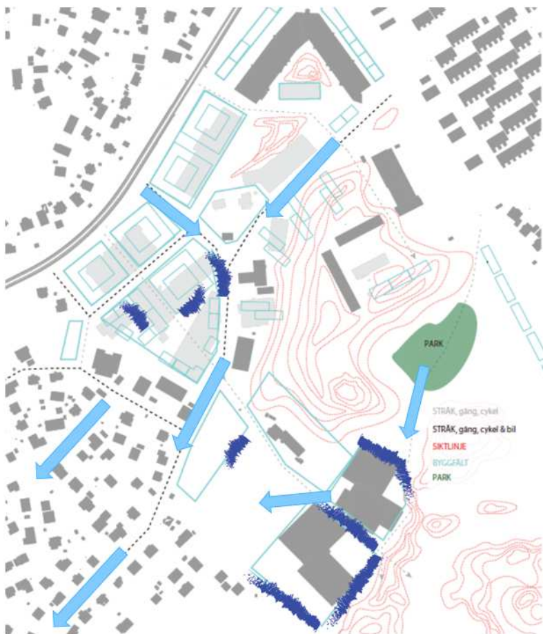
Figur i. Skyfallsleder med blå pilar och eventuella vattenansamlingar eller flödes påtryckningar vid skyfall mot nya kvarter, markerad med mörkblått.
