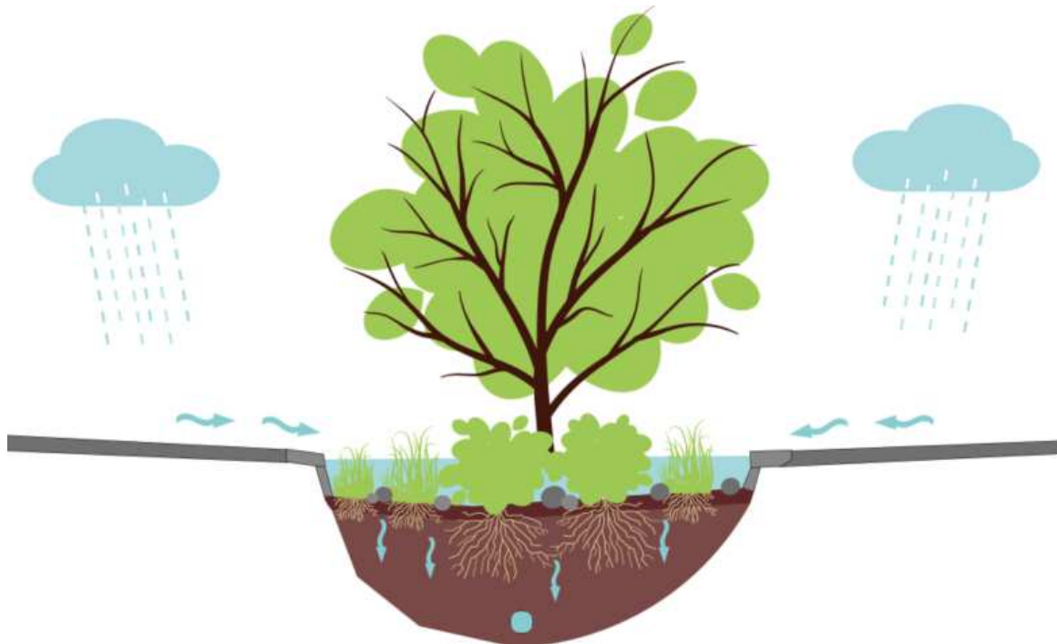
Figur 20: Biofilteranläggning i form av regnbädd/växtbädd, Bildkälla Ramboll.
