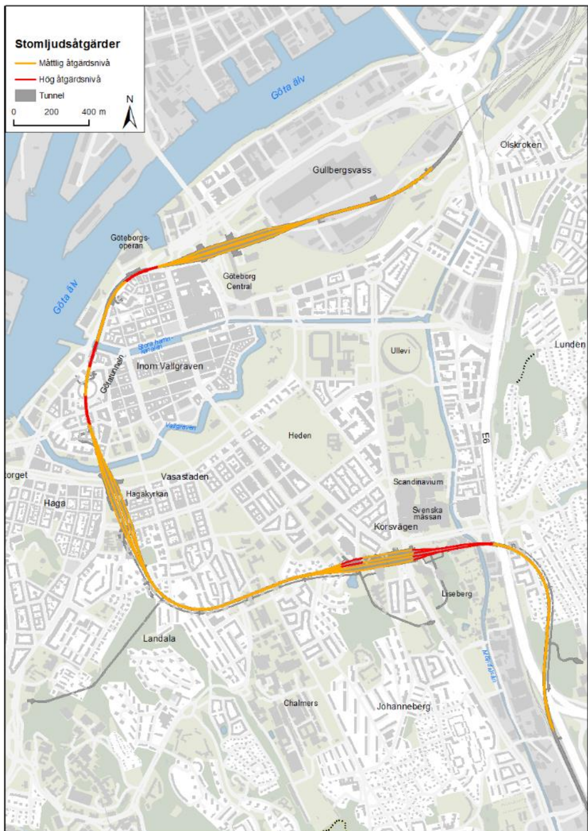
Figur 11.3 Behov av stomljusdämpande åtgärder i spåranläggning
