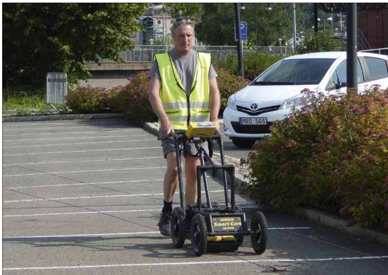
Figur 2. Georadarsystemet har vissa likheter med en barnvagn. Radarantennen är monterad på en glidplatta omedelbart ovanför markytan. På kontroll- och datauppteckningsenheten framför operatören visas vertikala profildata och viktiga mätparameter. För positionering av mätdata längs profillinjen finns ett distanshjul monterat på ett av vagnens hjul. Systemet körs längs med parallella profilsnören över undersökningsområdet.
