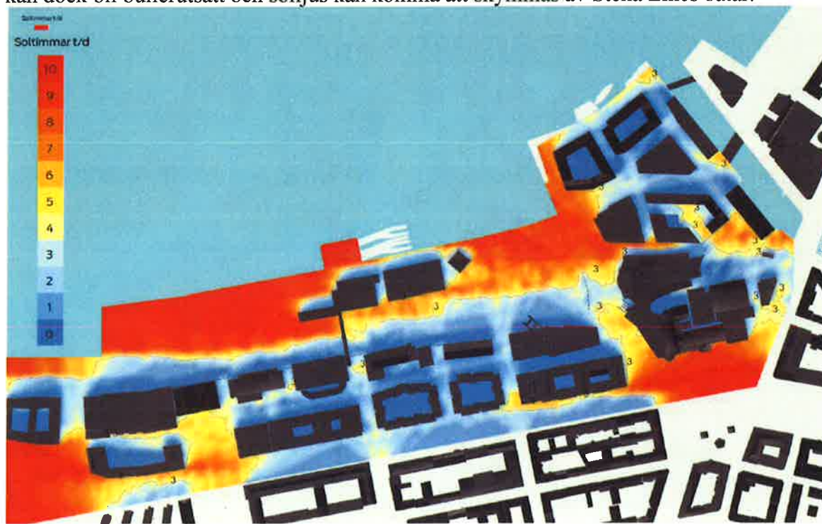
Solstudie för planförslaget under vår- och höstdagjämning klockan 8 - 18. Antal soltimmar illustreras av färger, mellan 0 - 10 timmar solljus.
