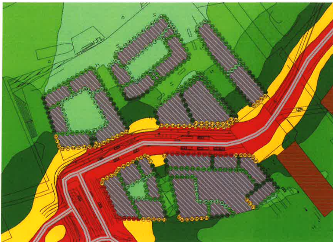
Ekvivalent ljudnivå för den östra delen av planområdet, norr om den östra parken. Beräkningen visar situation 2035.
